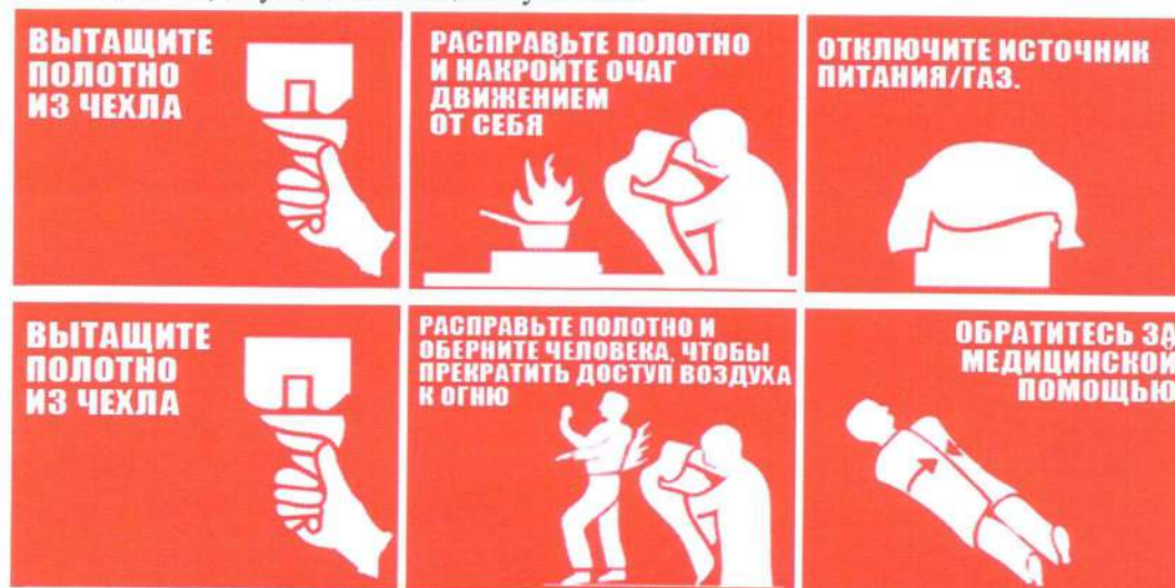
Рисунок 10 - Применение пожарного полотна для тушения горящего человека
